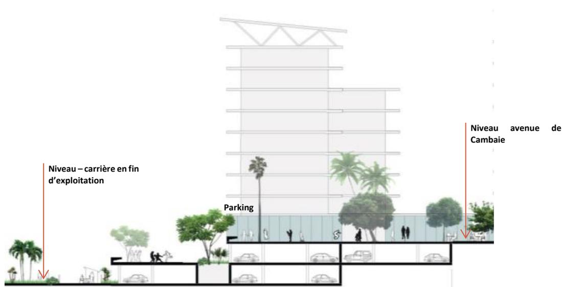
*Principe du stationnement en profitant de la déclivité avec les carrières. Ces parkings bénéficient d'une façade ouverte amenant lumière naturelle et ventilation et facilitant la reconversion si nécessaire.*
